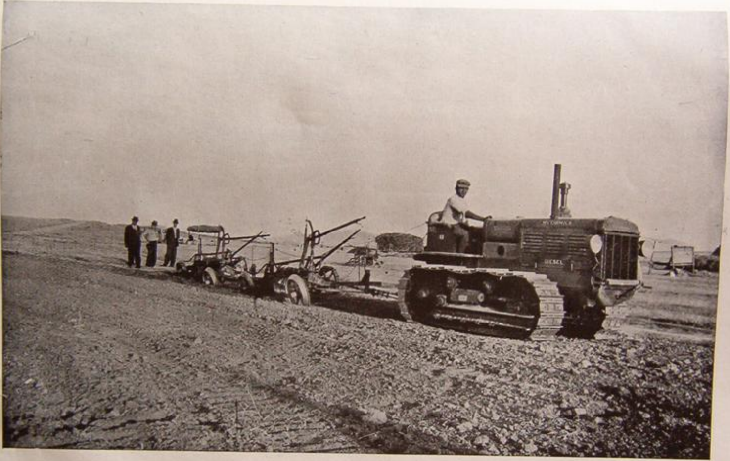
Eskişehirde, Drayfarming Örnek Çiftliğinde nadas hafriyatı (Orta Anadolu ziraatinde ancak 5.000 dönümlük bir çiftlik traktörü rentabl olarak kullanılabilir. 50 beygir kuvvetinde olan bu traktör günde 15 saat çalışarak 100 dönüm nadas çıkarır.)
